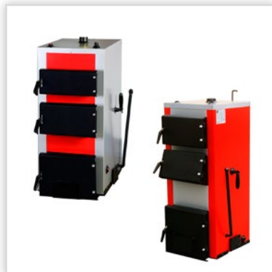
KDO-U [S]/[RW]. Kocioł dolnego spalania z rusztem żeliwnym [S]/wodnym [RW] oraz mechanicznym przegarniaczem paliwa. Paliwo: węgiel kamienny sortymentu orzech, przełącznik sposobu spalania dół/góra znacznie ułatwia rozpalanie w kotle oraz umożliwiła spalanie również gorszych gatunków paliw. Moc [kW]: 8-44. Sprawność [%]: do 84.
