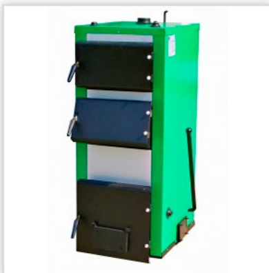
RUBIN/AGAT. Kotły górnego spalania z rusztem żeliwnym i mechanicznym przegarniaczem. RUBIN to najbardziej uniwersalna konstrukcja wymiennika pozwalająca na spalanie praktycznie każdego paliwa: węgiel o dowolnej granulacji, drewno, zrębki, trociny, itp. oraz mieszanki tych paliw z węglem. Zmieniona konstrukcja rusztu wodnego w kotle AGAT pozwala dodatkowo spalać koks i mieszanki koksujące. Moc [kW]: 10-35 (RUBIN), 14-65 (AGAT).
