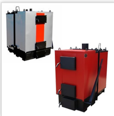
KDO MAX. Wodne niskotemperaturowe kotły centralnego ogrzewania wykonane w konstrukcji dolnego lub górnego spalania. Dwuczłonowa budowa ułatwia transport i montaż. Dostępna wersja z nadmuchem i sterownikiem. Paliwo: dolne spalanie – węgiel kamienny asortymentu groszek, orzech, węgiel z mieszankami paliw zastępczych (miał, węgiel brunatny), konstrukcja górnego spalania umożliwia także spalanie torfu, drewna i jego odpadów. Moc [kW]: 80-450. Stałopalność: do 12 godzin.
