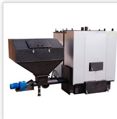
ECONOMIC MAX. To automatycznie sterowany kocioł z podajnikiem ślimakowym i bardzo efektywnym palnikiem węglowym o wysokich parametrach spalania ekogroszku. Kocioł ECONOMIC MAX należy do czołówek tego typu urządzeń ekologicznych na rynku. Zasobnik mieści około 700 kg paliwa. Kotły można łączyć w kaskady. Dwuczłonowa konstrukcja ułatwia transport i montaż. Sprawność [%]: do 85. Moc znamionowa [kW]: od 100 do 350.
