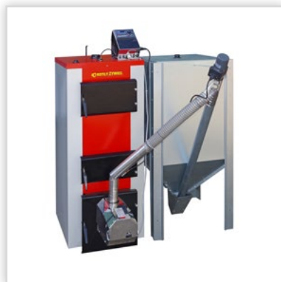
ECONOMIC BIO. Kocioł wielopaliwowy z palnikiem peletowym „ECO-PALNIK”. Wymiennik z rozbudowaną drogą przepływu spalin zapewnia wysoką sprawność pracy przekraczającą 90%. Moc [kW]: 20-75 (ECONOMIC BIO), 100-300 (ECONOMIC BIO MAX). Sterowanie: temperaturowe, współpracuje ze sterowaniem pokojowym, z możliwością podłączenia panelu pogodowego, obsługa dwóch pomp, automatyczne zapalanie i czyszczenie. Paliwo: pelet, (drewno, brykiet drzewny, węgiel-pry paleniu tradycyjnym).
