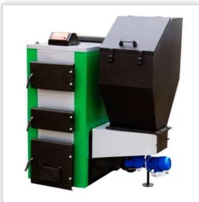
CARBON. Kocioł wielopaliwowy z automatycznym podajnikiem tłokowym. Konstrukcja palnika przystosowana jest do efektywnego spalania paliwa o granulacji od 0-32 mm (miał, groszek). Moc [kW]: 18-35.
